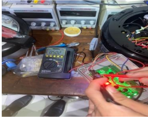
Gambar 3.4 Titik pengukuran input tegangan LCD I2C 20x4
