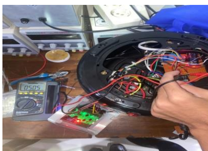
Gambar 3.1 Titik pengukuran output Power Supply
