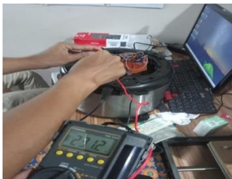
Gambar 3.5 Titik pengukuran input tegangan Heater
